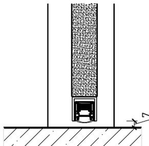
Anschlagwinkel mit Dichtung 40x30
