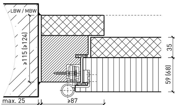
Blockrahmen 94 / 103 mm, Türe stumpf mit RC4 / FB4-Doppel
