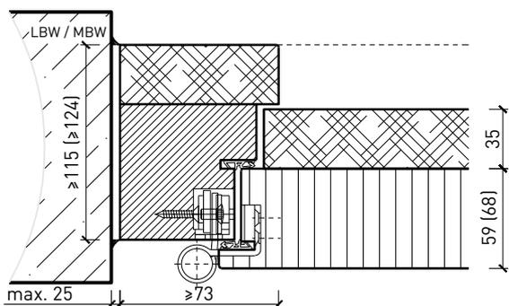
Blockrahmen 94 / 103 mm, Türe stumpf mit RC4-Doppel
