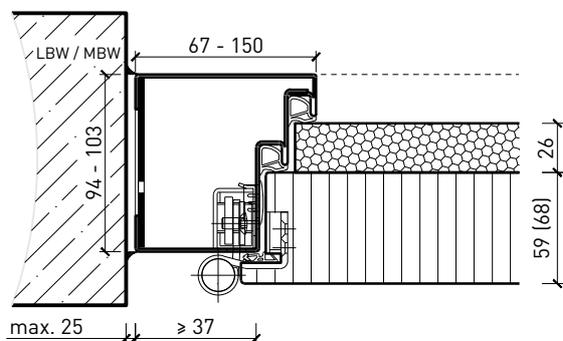
Stahlblockzarge, Türe stumpf mit Akustikdoppel
