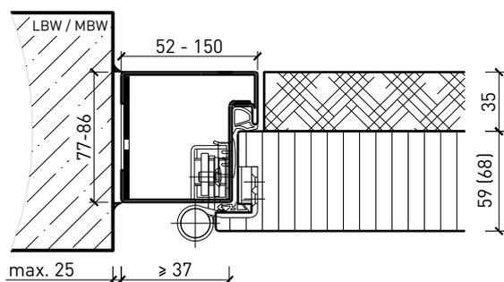
Stahlblockzarge, Türe stumpf mit RC4-Doppel
