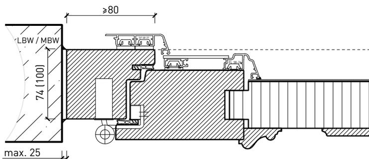
Mittelanschlag 74 / 100 mm, Schlagleisten profiliert
