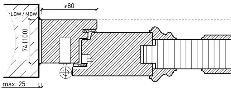
Mittelanschlag 74 / 100 mm, Schlagleisten profiliert
