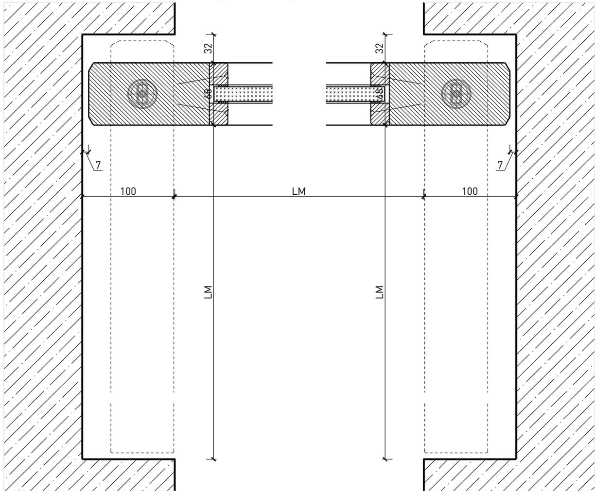
Pendeltür rahmenlos, zwischen Mauerwerk montiert
