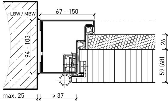
Stahlblockzarge, Türe stumpf mit Akustikdoppel
