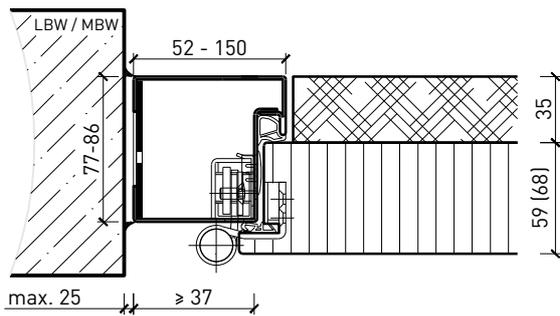
Stahlblockzarge, Türe stumpf mit RC4-Doppel
