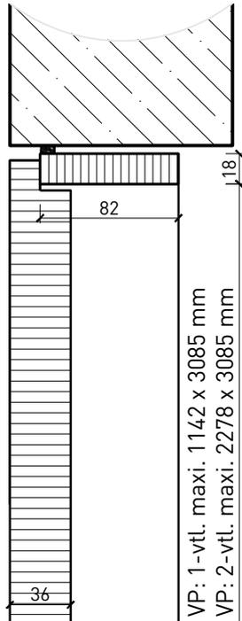
Raccord au plafond avec parement
