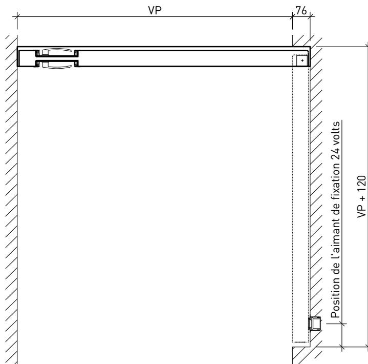
Avec frise de cadre supérieure et ferme-porte au sol profondeur de niche 98 mm
