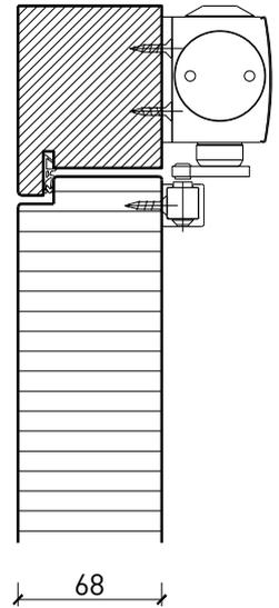
Butée avec joint d'étanchéité 40x30\*
