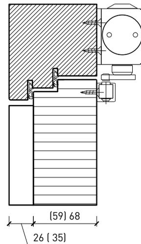
Butée avec joint d'étanchéité 40x30\*
