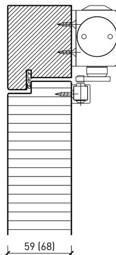
Butée avec joint d'étanchéité 40x30\*
