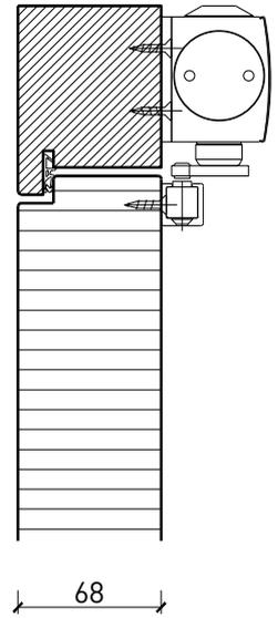
Butée avec joint d'étanchéité 40x30\*
