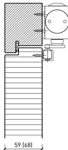
Butée avec joint d'étanchéité 40x30\*
