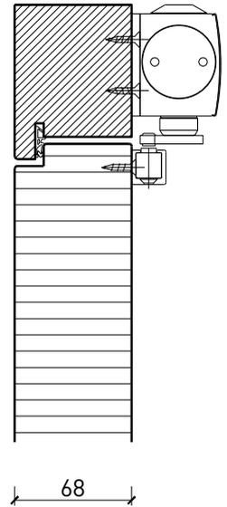
Butée avec joint d'étanchéité 40x30\*
