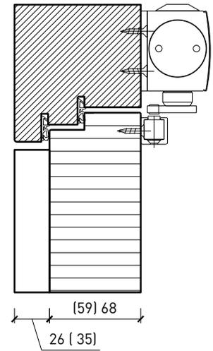
Butée avec joint d'étanchéité 40x30\*
