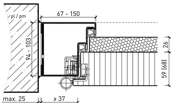
Cadre bloc métallique, porte affleurée avec doublage acoustique
