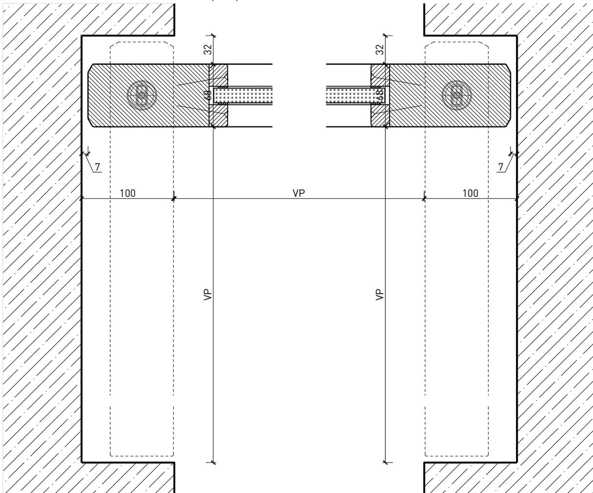
Porte battante sans cadre, installée dans la maçonnerie
