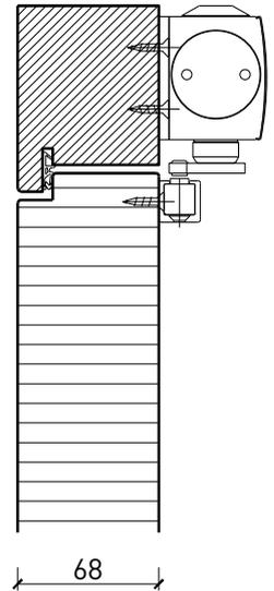
Butée avec joint d'étanchéité 40x30\*
