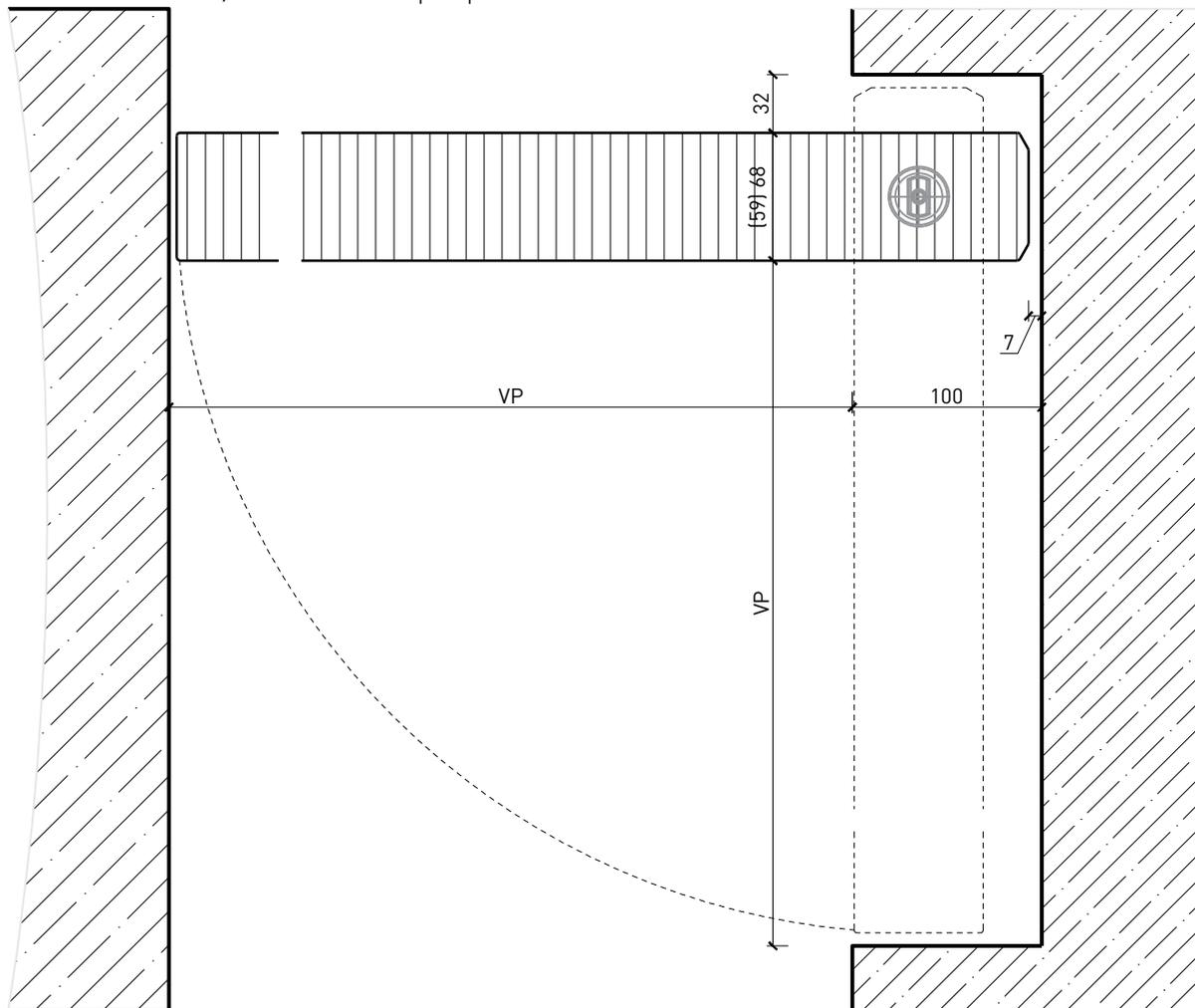
Porte battante sans cadre, installée dans la maçonnerie
