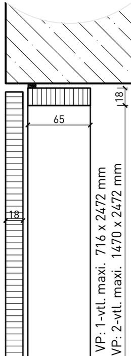
Raccord au plafond avec parement
