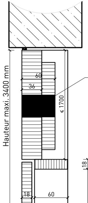
Raccord au plafond de cloison pour gaines techniques dans paroi pleine FeuerschutzTeam
