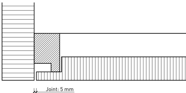
Combinaison entre cloison pour gaines techniques et paroi FeuerschutzTeam
