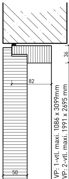
Raccord au plafond de cloison pour gaines techniques dans paroi pleine FeuerschutzTeam
