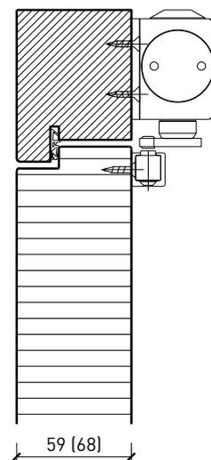
Butée avec joint d'étanchéité 40x30\*
