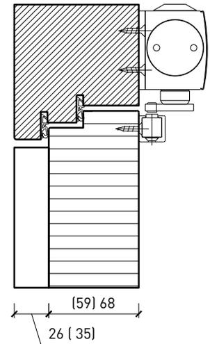
Butée avec joint d'étanchéité 40x30\*
