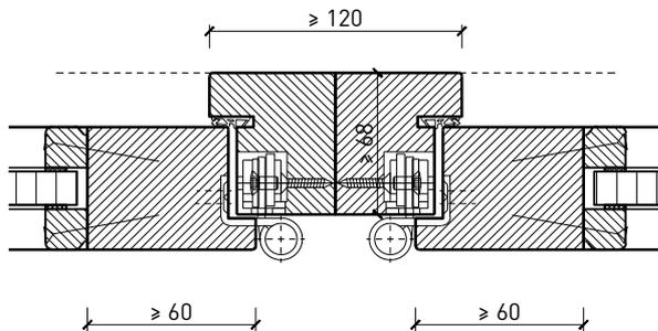
Blockrahmen-Kopplung 68 mm, Türe stumpf
