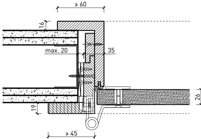
Ganzlastür 26 mm, stumpf einschlagend in Holzblockrahmen
