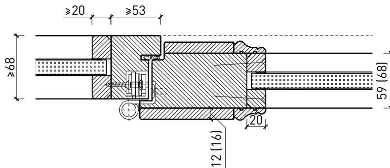
Einbau in Vollwand, Türe gefälzt
