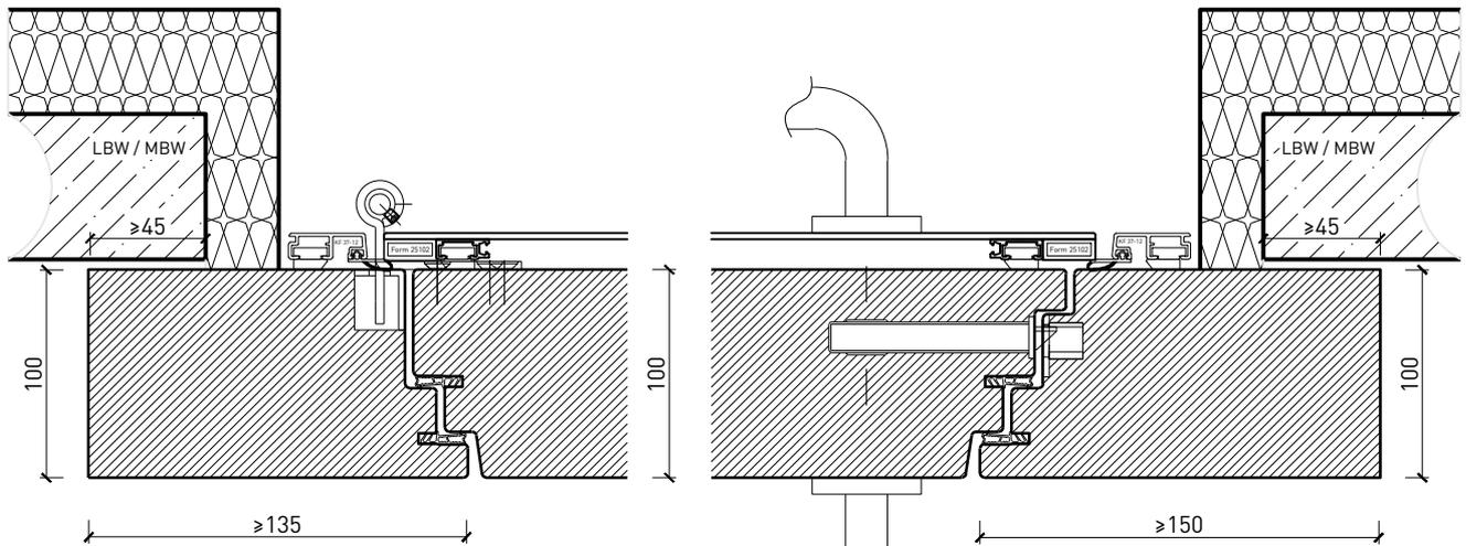
Blockrahmen 100 mm, Türe stumpf nach aussen öffnend
