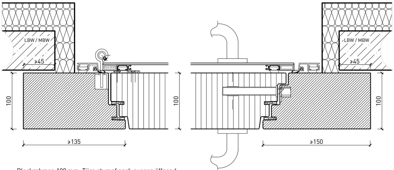
Blockrahmen 100 mm, Türe stumpf nach aussen öffnend
