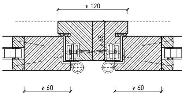
Blockrahmen-Kopplung 68 mm, Türe stumpf
