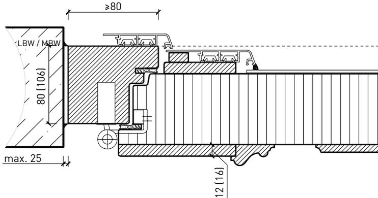
Mittelschlag 74 / 100 mm, Schlagleisten profiliert
