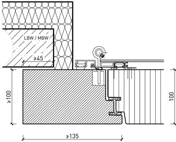
Blockrahmen 100 mm, Türe stumpf nach aussen öffnend
