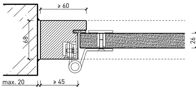
Ganzlastür 26 mm, stumpf einschlagend in Stahlfassungszarge
