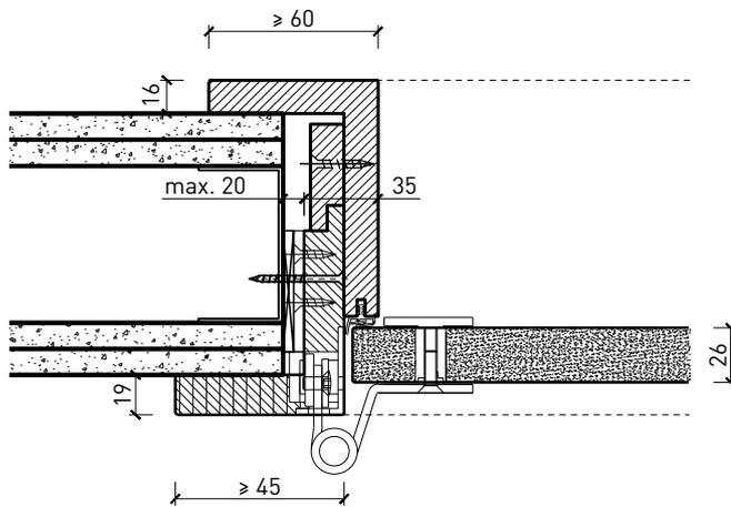
Ganzlastür 26 mm, stumpf einschlagend in Holzblockrahmen
