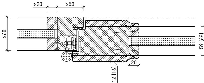
Einbau in Vollwand, Türe gefälzt
