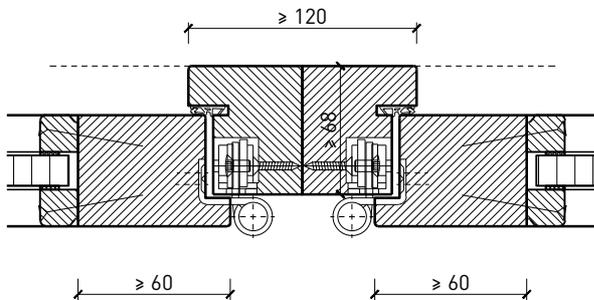
Blockrahmen-Kopplung 68 mm, Türe stumpf
