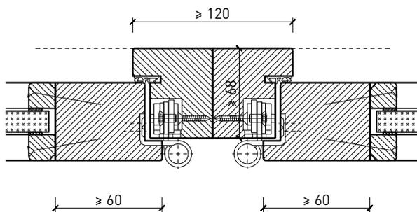
Blockrahmen-Kopplung 68 mm, Türe stumpf
