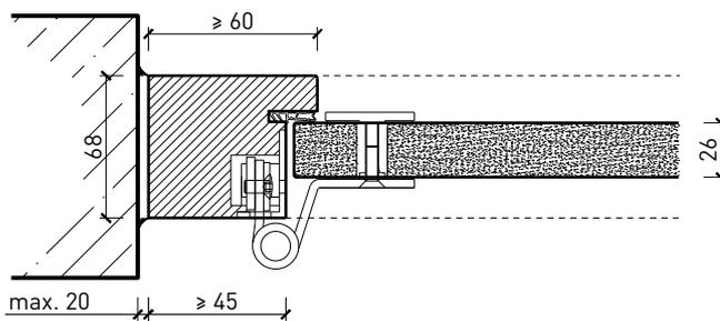
Ganzlastür 26 mm, stumpf einschlagend in Stahlfassungszarge
