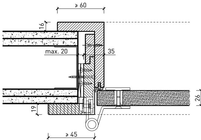
Ganzlastür 26 mm, stumpf einschlagend in Holzblockrahmen
