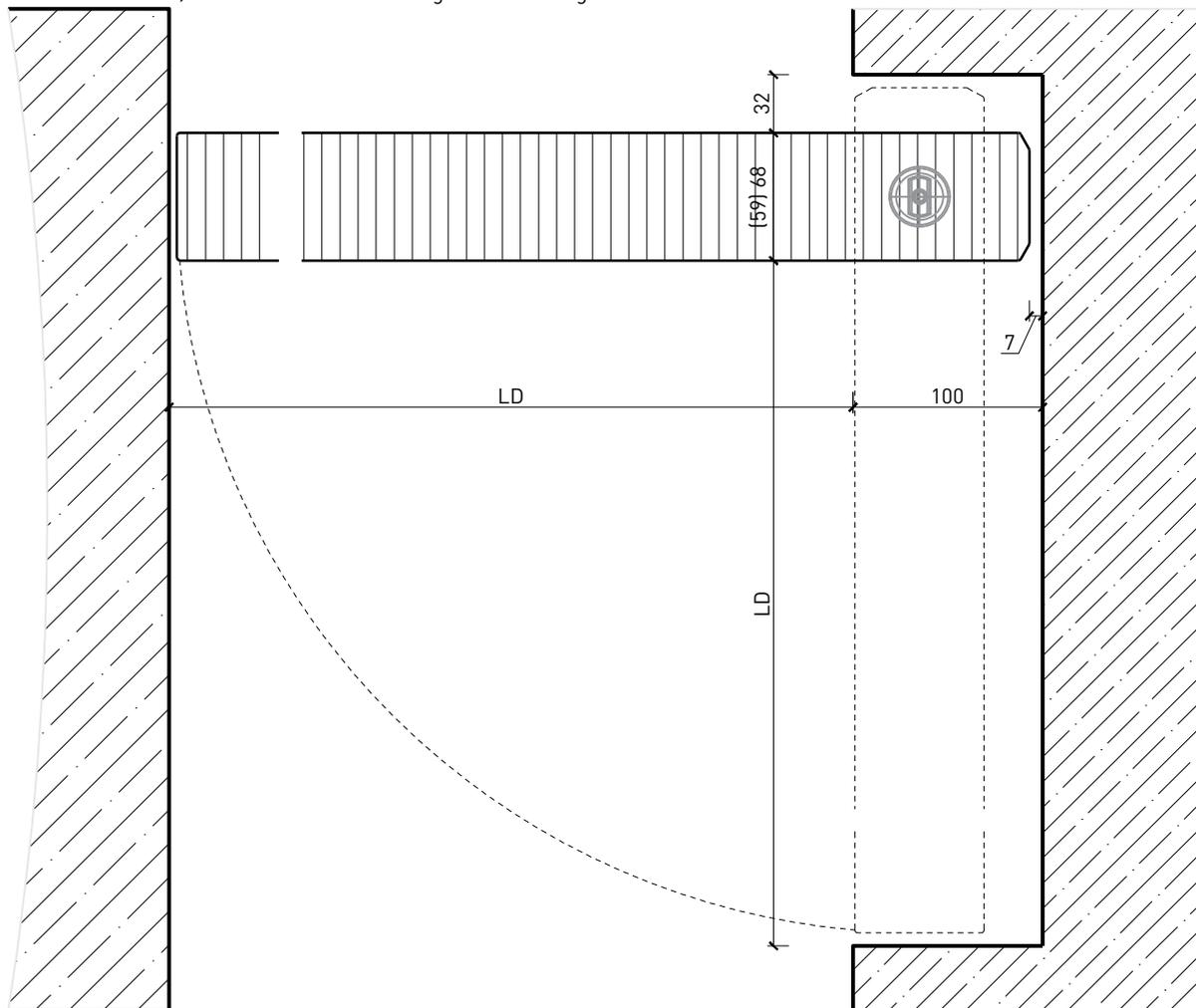
Pendeltür rahmenlos, zwischen Mauerwerk montiert
