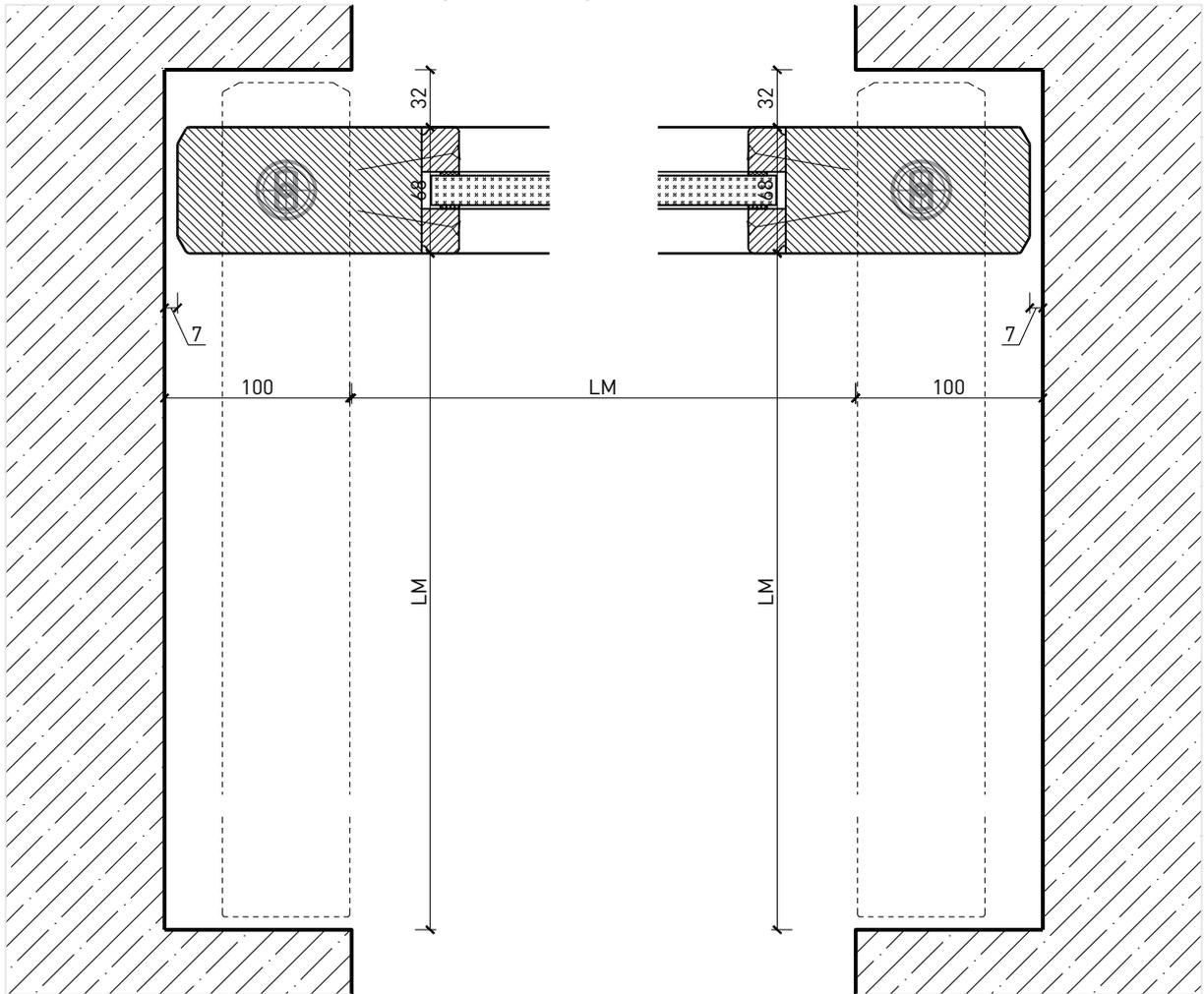
Pendeltür rahmenlos, zwischen Mauerwerk montiert
