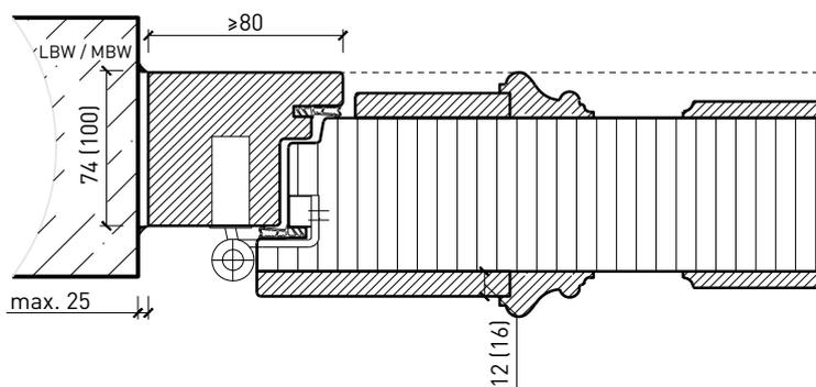
Mittelanschlag 74 / 100 mm, Schlagleisten profiliert
