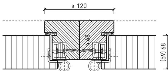
Blockrahmen-Kopplung 68 mm, Türe stumpf
