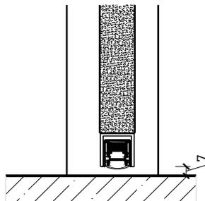
Anschlagwinkel mit Dichtung 40x30
