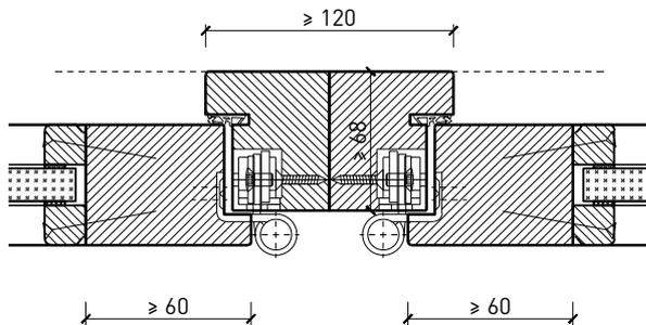
Blockrahmen-Kopplung 68 mm, Türe stumpf
