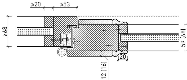
Einbau in Vollwand, Türe gefälzt
