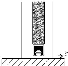
Anschlagwinkel mit Dichtung 40x30
