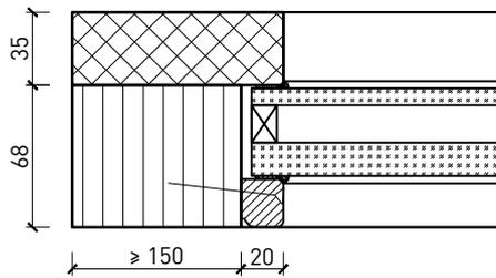
Glas mit Metallwinkel eingebaut
