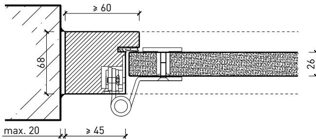
Ganzlastür 26 mm, stumpf einschlagend in Stahlfassungszarge
