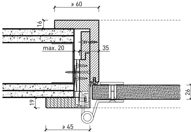
Ganzlastür 26 mm, stumpf einschlagend in Holzblockrahmen
