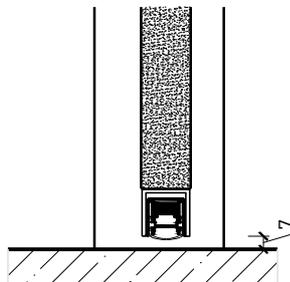
Anschlagwinkel mit Dichtung 40x30
