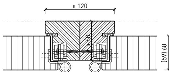
Blockrahmen-Kopplung 68 mm, Türe stumpf
